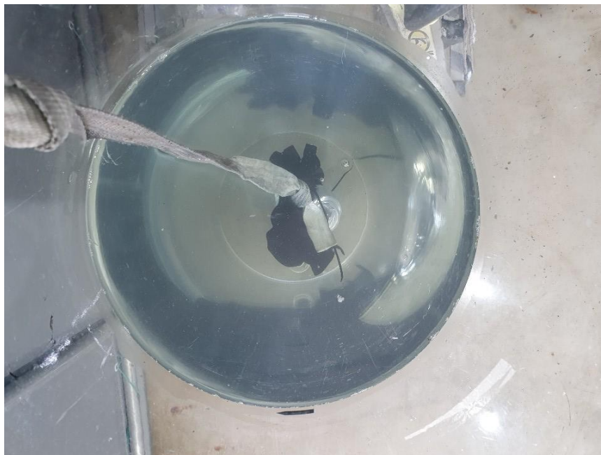
< 사진 4 > 제 2특성 숫자 시험 사진
