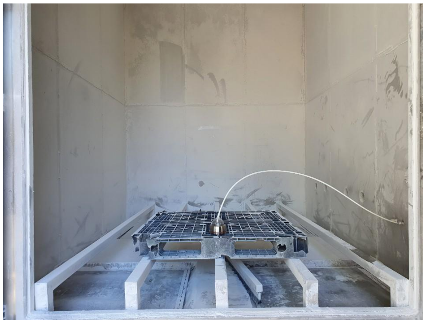
< 사진 4 > 제 2특성 숫자 시험 사진
